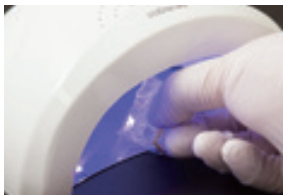
4. 型が密着するよう、手で軽く押さえたまま UV-LED ライト (24W ~) を 60 秒照射する
