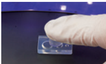
7. 底部分にレジンを塗った本体を、底部分に押し当てたまま、UV-LED ライト (24W ~) を 10 秒程度照射する
