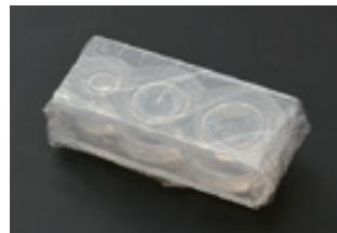
3. フタの型にレジンを満たし、ラップで包み、型を固定し、UV-LED ライト (24W ~) を 120 秒程度照射する
